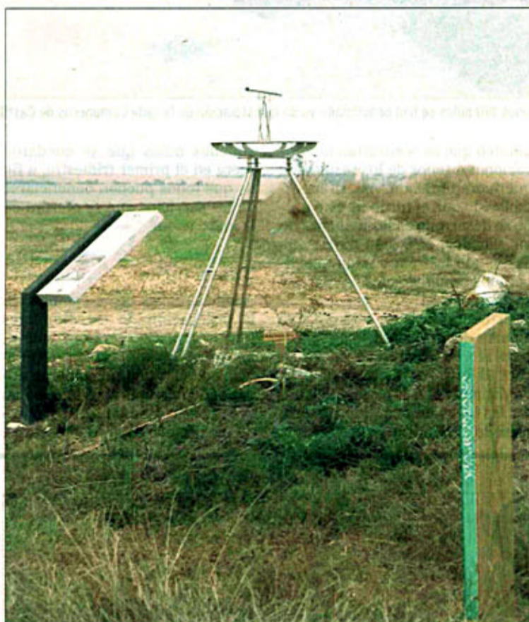
Con el uso de la Dioptra los romanos diseñaban sobre el terreno el trazado. / G. GONZÁLEZ
