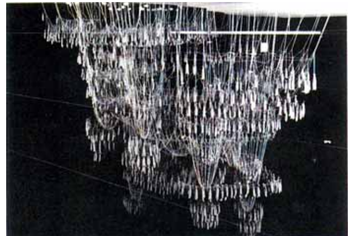
Fig. 4. Maqueta de funiculares de la iglesia de la Colonia Güell realizada por Gaudí.
