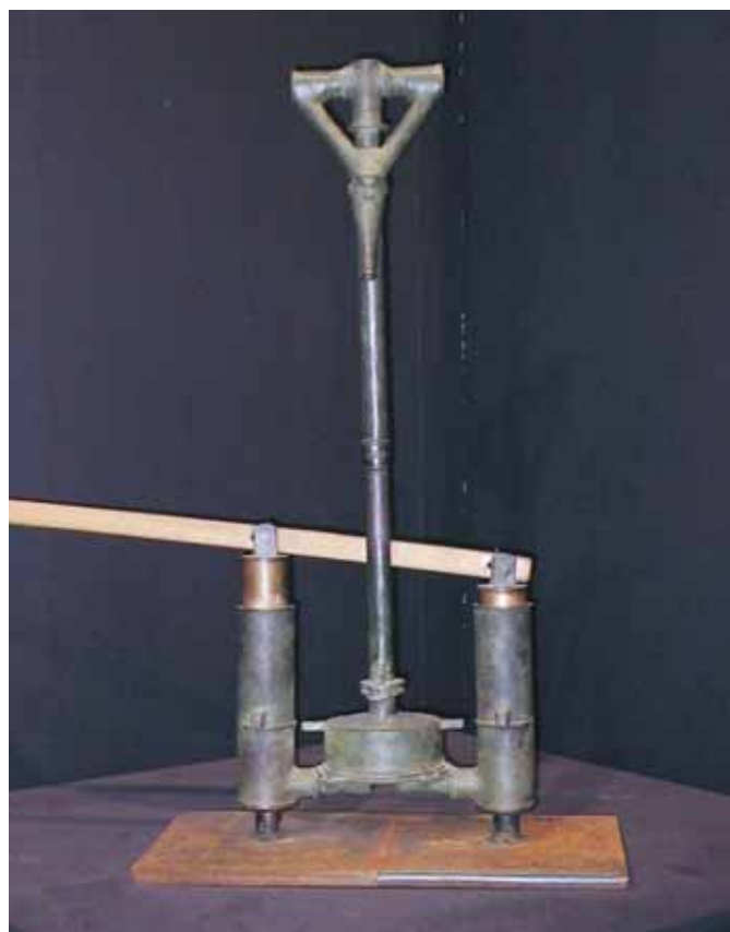
Fig. 10. Bomba de Ctesibio, similar a la usada por los bomberos en Roma (CEHOPU).
