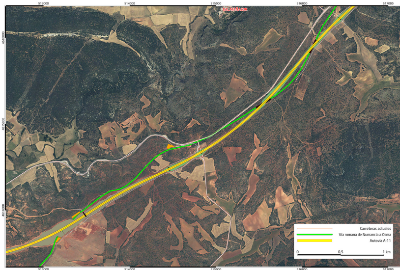
Plano general sobre ortofoto donde se ve el tramo de autovía A-11 que afectaba a la vía romana de Numancia a Osma (en verde) y como esta cruza dos veces bajo la autovía, manteniendo la continuidad del corredor en todo ese tramo.
