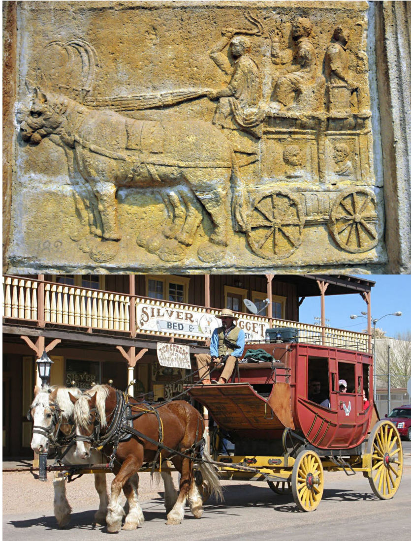
Figure 7, Comparación entre los atalajes de la carruca de magistrados del museo Calvet (Avignon-Francia) y una diligencia moderna. Ambas llevan caballos percherones con collera, barrigueras, retranca, etc.
