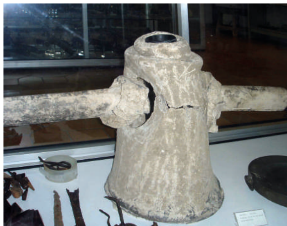
Fig. 24. 'Ventosa' o válvula de extracción de aire de las tuberías. Colección Romul Gabarró.
