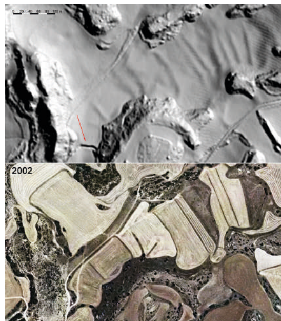
Fig. 55. Arriba, modelo de elevación LIDAR donde se ve el desnivel de la finca donde está la supuesta presa (fecha en rojo) y los antiguos muros que la dividían para hacerla cultivable. Abajo, ortofoto del PNOA de 2022, donde aún se ven perfectamente los muros que dividían la finca, todos idénticos a la supuesta presa, y que desaparecieron en fecha tan reciente como en 2007.
