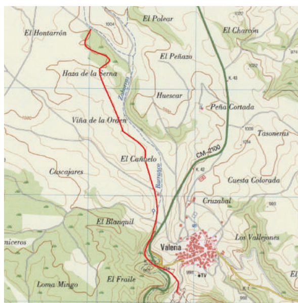
Fig. 24. En rojo, trazado hipotético del conducto a presión (sifón invertido) entre la captación en El Hontarrón y los decantadores del foro, pasando por el pago de topónimo “El Cañuelo”, por las rocas talladas citadas en el texto y la cama de hormigón excavada en el Hoyos occidental.
